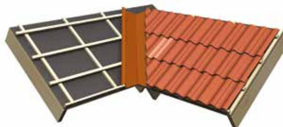
Bild 14. Utförande av rännedal Rännedalar är känsliga delar av takkonstruktionen och skall utföras omsorgsfullt. Pannorna skall kapas i raka linjer och spolats rena från damm omgäende.
