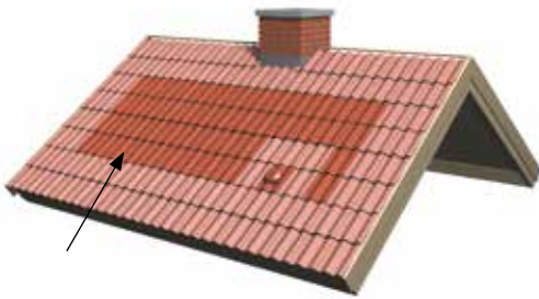
Bild 10. De ljusst markerade pannorna fästes alltid.
