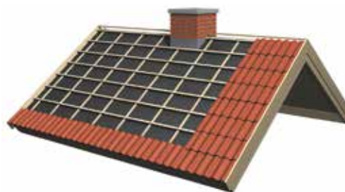
Bild 9. Lägg först en nedre rad från höger till vänster. Forsätt sedan med en rad ända upp till nocken. Se till att den ligger i vinkel mot nedersta pannraden.
