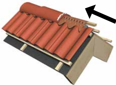
Bild 11. Ventilation av traditionellt papptäckta tak med slutna noken. Benders ventinock är spikad på nockbrädan och tätar mot inblåsande av regn och snö. Samtidigt medges luftcirkulation under takpannorna. Torra tak ruttnar inte! Nockpannorna läggs mot vindriktningen, se pil. Täta och skruva allt spika.
