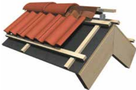
Bild 12. Benders nock och valmtättningsrulle är lätt att montera. Rulla ut en längd på nockplankan, spika eller häfta fast den. Ta sedan bort skyddstejpen på undersidan av rullen och tryck fast och forma mot takpannorna. Underlaget skall vara torrt och dammfritt och temperaturen bör vara minst +8°. Nock- och valmtättningsrullen finns i 300 mm bredd.
