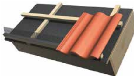
Bild 13. Fägelbandet monteras vid takfoten för att förhindra att fåglar bygger bo under takpannan. Det finns även ventilerat fägelband, används för tak med takfotskil.
