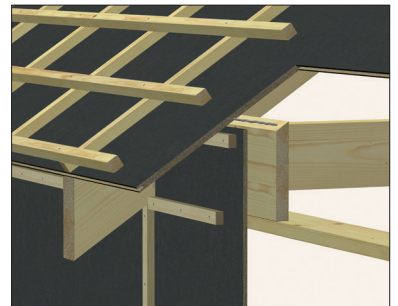
D10. Övergång vägg/tak med utstickande takstolar
