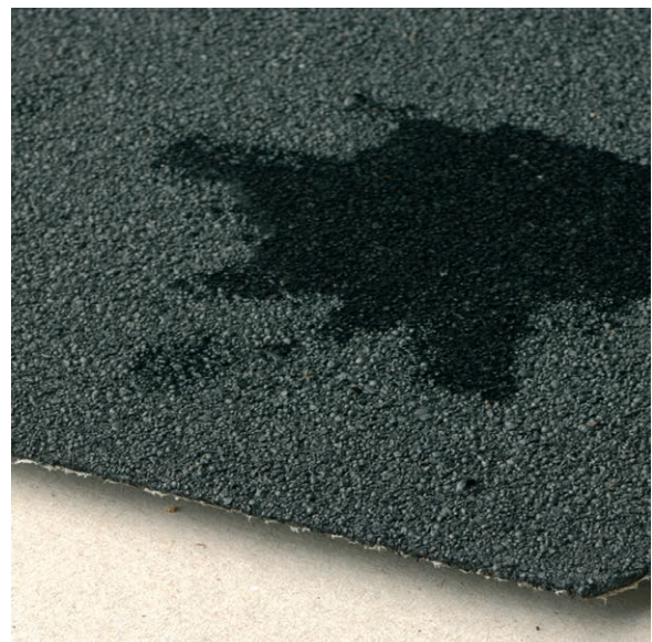
Enklare takshingelvarianter. Bilden visar ovansidan av enklare shingelversioner.
