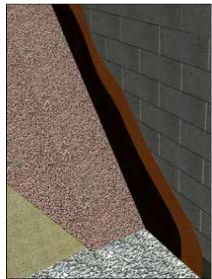
Bild 5.5. Källarvägg med LECA lättklinker
