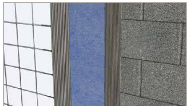
Bild 5.6. Tätskiktsapplikation på LECA block
