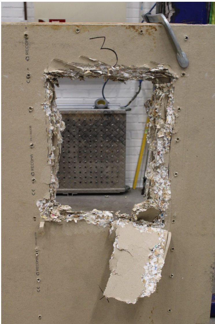
Figur 9 - Forcerad vägg efter angrepp, Test 3 (3 skivor)
