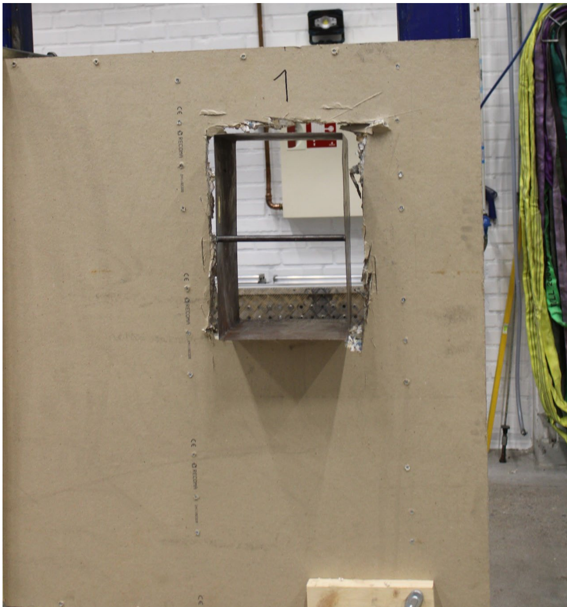
Figur 6 - Forcerad vägg efter angrepp, Test 1 (1 skiva)
