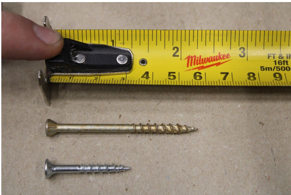
Figur 1 - Skruv som användes för montage av provobjekt (55 mm träskruv för montage av träreglar resp. 30 mm gipsskruv för montage av skivor i träreglar)
