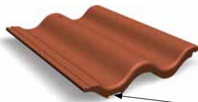
Bild 18. Spårpanna Palema, förproducerad spårpanna, inga urskärningar krävs. Urtaget är 5x35 mm.
