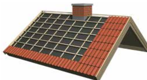
Bild 9. Lägg först en nedre rad från höger till vänster. Forsätt sedan med en rad ända upp till nocken. Se till att den ligger i vinkel mot nedersta pannraden. Forsätt med två - tre rader i taget ända upp. Kontrollera att raderna ligger rakt.
