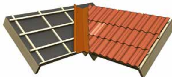
Bild 16. Utförande av rännadal Rännadalar är känsliga delar av takkonstruktionen och skall utföras omsorgsfullt. Pannorna skall kapas i raka linjer och spolats rena från damm omgäende.
