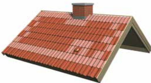
Bild 12. Infästningsmönster för Easy Clip och Stormclips, där de ljusst markerade pannorna alltid fästes.
