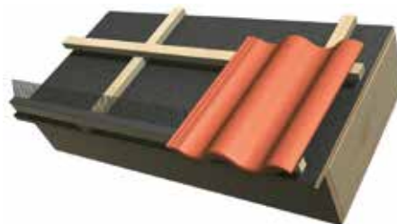
Bild 15. Fågelbandet monteras vid takfoten för att förhindra att fåglar bygger bo under takpannan. Det finns även ventilerat fågelband, används för tak med takfotskil.
