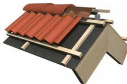
Bild 3. Avståndet från nockspetsen till övre bärläkten skall vara ca 30 mm, se bild 5. Prova att nockpannan täcker översta pannradens spikhål.
